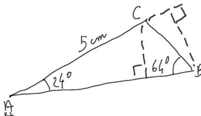
Le triangle ABC n'est pas rectangle, on ne peut donc pas utiliser la trigonométrie dans ce triangle... il faut donc prendre l'initiative d'introduire un triangle rectangle dans la figure, par exemple en traçant une des hauteurs de ABC que nous avons fait figurer sur notre dessin à main levée.
