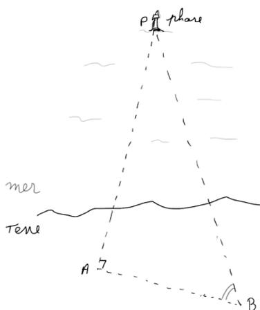
Plaçons un point B sur la terre ferme, de façon à ce que le triangle PAB soit rectangle, mesurons l'angle  $\widehat{ABP}$  (ce qui est possible par des visées, sans quitter le point B), et la longueur AB. Nous supposons dans la suite de cet exemple que  $AB = 1700$  m et  $\widehat{ABP} = 59^\circ$ .
